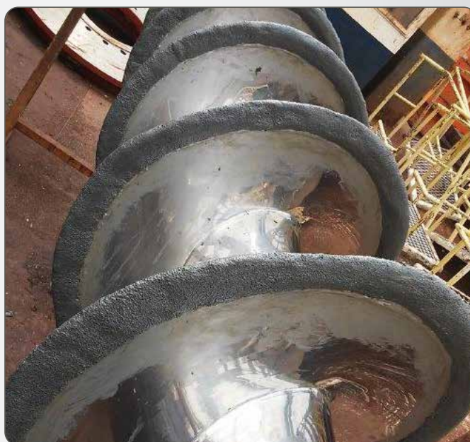
PROTEÇÃO DE ROSCA TRANSPORTADORA COM PLASTEEL DIAMANTADO.
